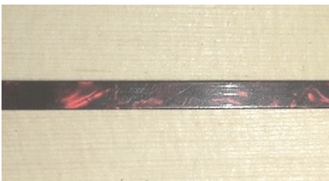
Binding – Die Einlage in die Falz, der Kanten von Decke und Boden, mit der Zarge
